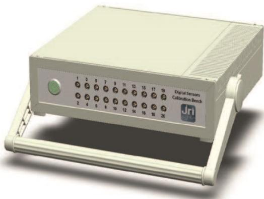
Le banc d'étalonnage JRI utilise la communication en 2.4 GHz avec un Nano SPY LINK pour envoyer les données vers MySirius. Voir la notice d'utilisation pour le montage et la mise sous tension avant utilisation.
